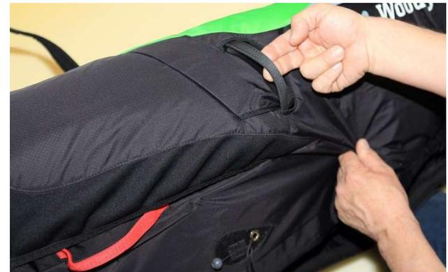
Dieses System ermöglicht es Ihnen, den Bremsschirm herauszuziehen und während der Landephase fest in der Hand zu halten, und dann genau im richtigen Moment zu öffnen.
