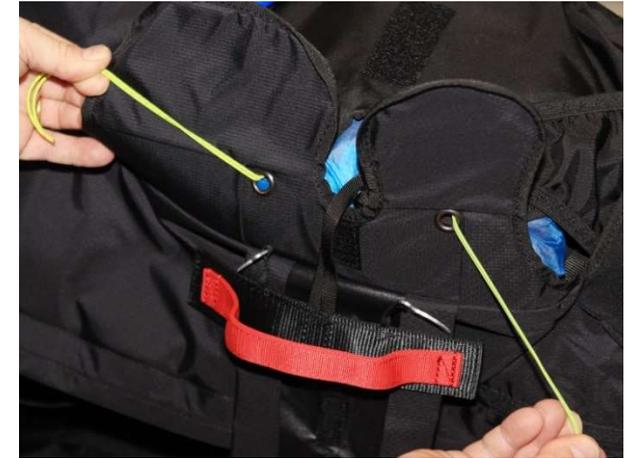
Die Metallstecker des Griffs in die elastischen Schlaufen einführen. Die Schnur muss am Ende dieser Phase vollständig entfernt werden. Ziehen Sie sie dazu langsam heraus, um die elastischen Schlaufen nicht durch übermäßige Reibung zwischen den Teilen zu beschädigen. Am Ende muss der Griff unter die elastische Abdeckung eingesetzt werden. Die Endabdeckung so anordnen, dass sie eng anliegt und den Klett des Griffs bedeckt.
