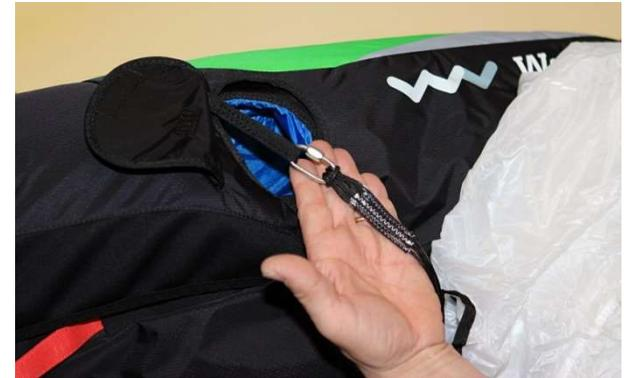
Die Seile und die Fallschirmkappe wieder sorgfältig und unter Berücksichtigung der Größe der Innentasche zusammenlegen. Den zusammengelegten Fallschirm in die Tasche legen und den Auslösegriff heraus lassen, der alles mit dem Klettverschluss blockiert. Den äußeren Schalendeckel in den Griff schieben und anschließend ins Inneren der Tasche, die den Fallschirm enthält.
