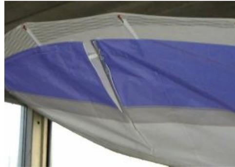
Alle Reißverschlüsse öffnen und die VG-Schnur aus der Klemme ziehen. Nasenverkleidung abnehmen und Nasenbeschlag vorsichtig entspannen
