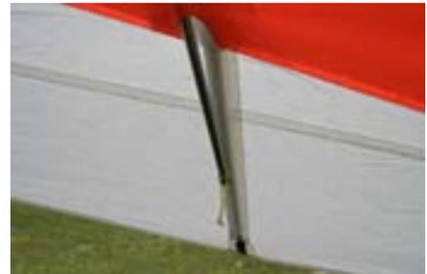
Die Untersegellatten werden von den Lattentaschen links und rechts entfernt. Anschließend werden die integrierten Segellatten (Klick-System) von außen (grün – rot) geöffnet und bis auf die letzten 3 Segellatten am Kiel entfernt.
