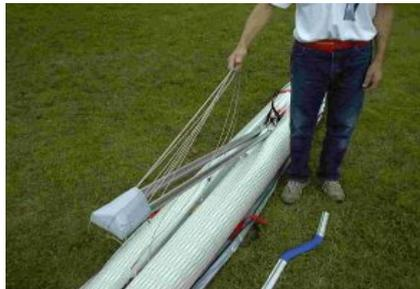
Nasenverkleidung, Speedbar und Segellatten in den Packsack hinten einlegen und Reißverschluß schließen.
