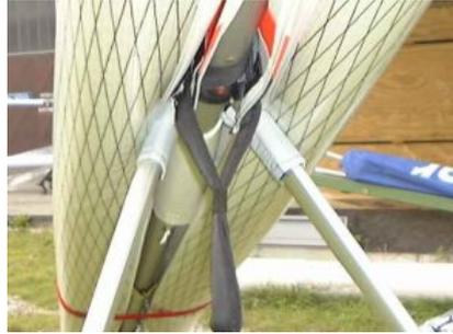
Nun werden die beiden Flügelenden zusammengeführt und mit den Velkrobänder verpackt. Den Packsack von der Nase beginnend zum Flügelende über den Gleiter stülpen. Den Drachen umdrehen und mit dem Packsack auf den Boden legen. Dazu mit einer Hand an der Nase und mit der anderen Hand an das gegenüberliegende
